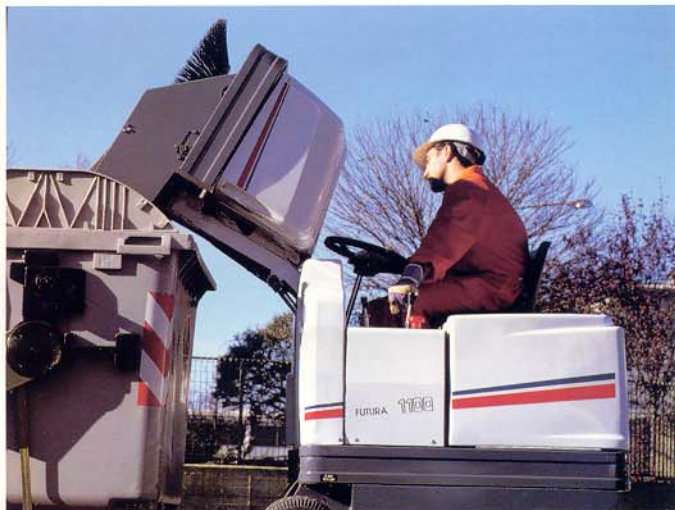
Scarico in quota
