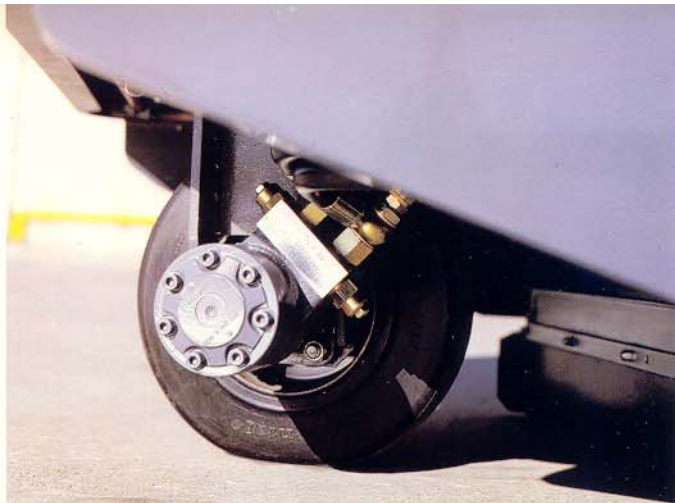
Trasmissione diretta con motoruota
