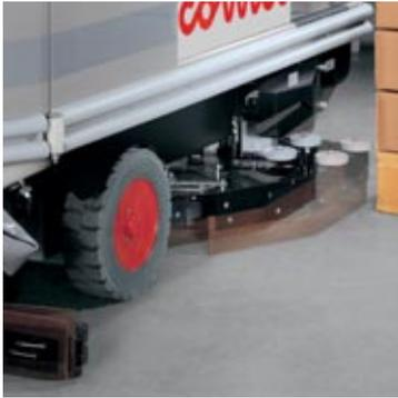
Il gruppo lavante è dotato di due spazzole controrotanti e può traslare lateralmente per facilitare la pulizia lungo muri e scaffali. In caso di urto laterale il basamento rientra automaticamente senza la necessità di alcun comando (è in grado di assorbire gli urti)
