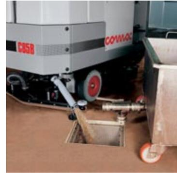
Lo scarico del serbatoio di recupero è nella parte inferiore destra posteriore della lavasciuga, in maniera da renderne molto agevole lo svuotamento. Togliendo il tappo, in meno di tre minuti il serbatoio è vuoto, pronto per un altro ciclo di lavoro
