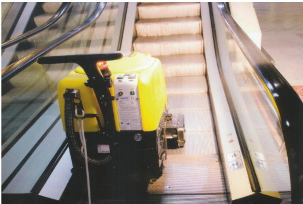
**Escalator**, lavasciuga scale mobili, è dotata di spazzole particolari che, con la loro conformazione specifica, si adattano ad ogni tipo e marca di scala mobile o tappeto e consentono un lavaggio in profondità, ottenendo, in pochi giri della scala, una pulizia totale. Queste spazzole hanno una particolare struttura e insetolatura che permette di raggiungere le profonde cavità degli elementi che compongono la scala mobile.
